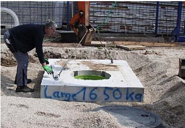
Bild 16: SLW60-Versuch LARGE mit Stb-Platte
