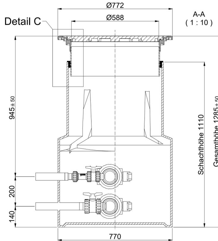
Schachtabdeckung DN600, nach Erdbau belastbar bis max. 1,5t Radlast, befahrbar, tagwasserdicht, teleskopierbar
