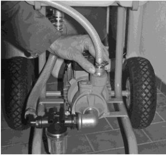
1. Druckschlauch am Pumpenausgang anschließen
